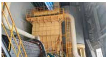
生产过程中所产生的粉尘经过收尘装置进行回收再利用
