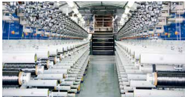
中复神鹰T1000级碳纤维生产线
