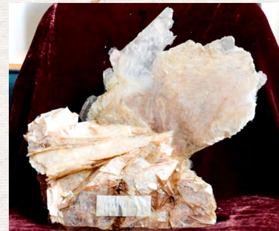
1963年12月，非金属矿研究所（中材人工晶体研究院前身）成功试制毫米级合成云母样品，不仅填补了国内空白，也为我国合成云母事业的快速发展奠定了坚实基础
