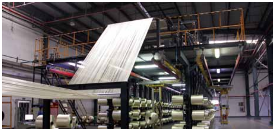
碳纤维原丝生产线
