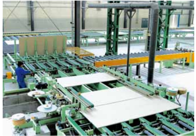
石膏板生产线
