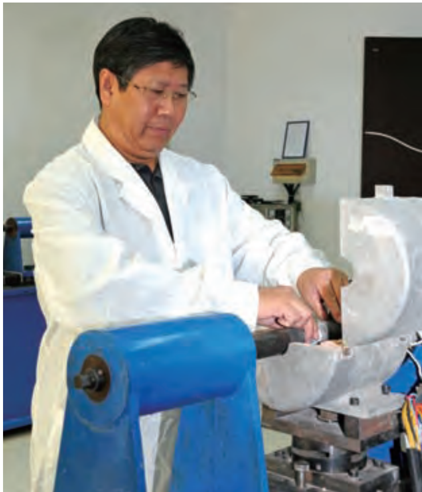
李国恩在进行倒像器扭转工艺试验
