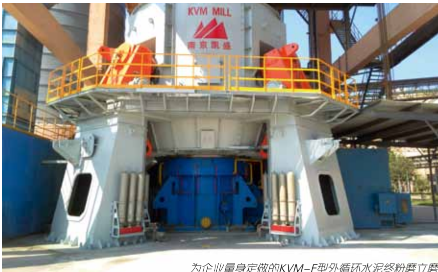
为企业量身定做的KVM-F型外循环水泥终粉磨立磨
